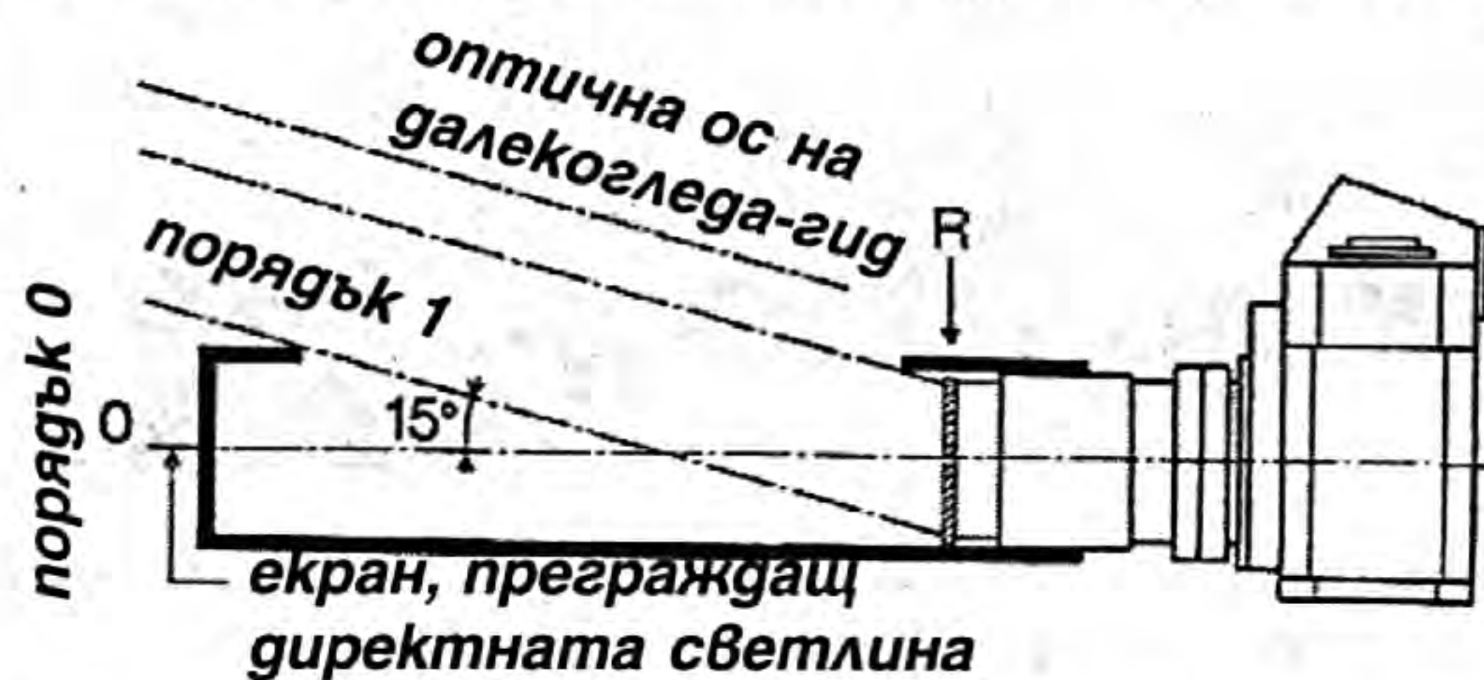
Детайл от конструкцията на спектрограф.
