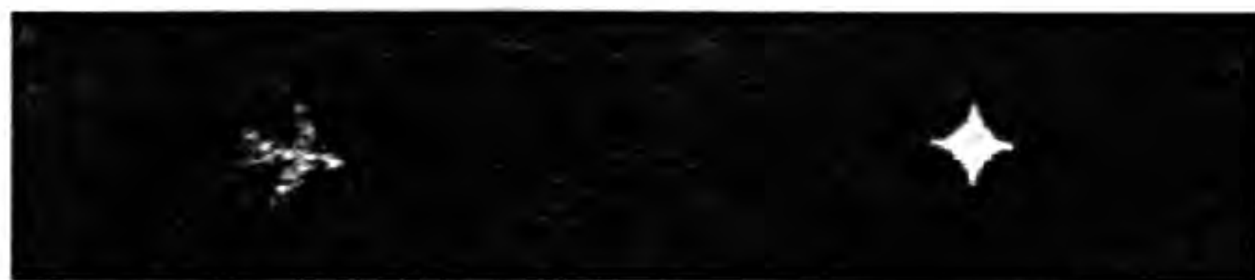
Вид на звезда, далеч от оптичната ос. Отляво, без корекция. Отдясно, с коректор.
